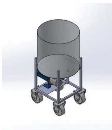
รูปที่ 6 ถังพักน้ำบุก[6]
