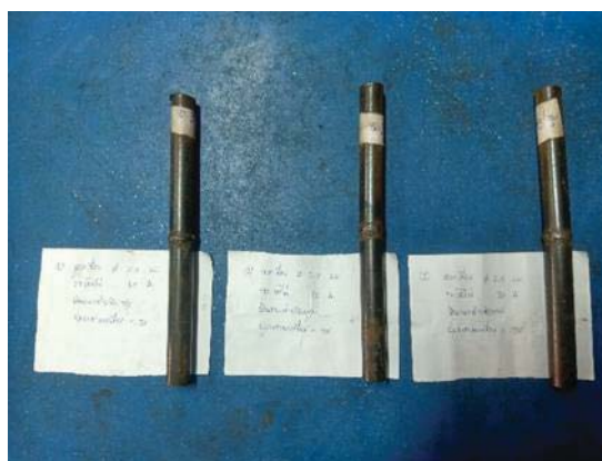
รูปที่ 6 แสดงวิธีการเชื่อมท่อตามการตั้งค่าพารามิเตอร์ที่แตกต่างกันไป
