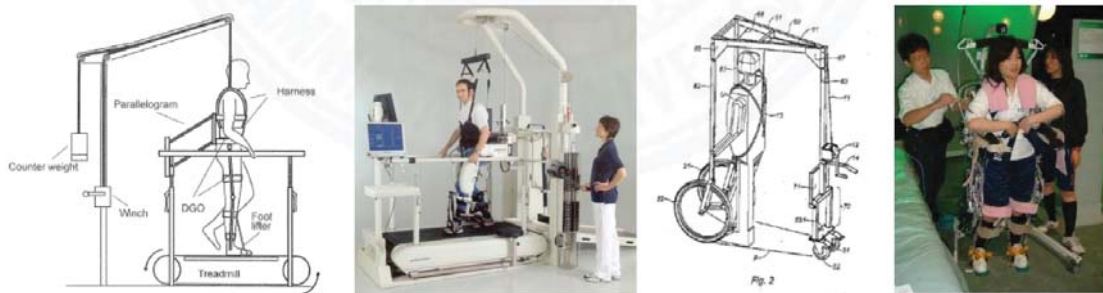
รูปที่ 3 การยกตัวโดยใช้รอกดึงขึ้นในแนวตั้งฉากกับพื้นและใช้น้ำหนักถ่วงผั่งตรงข้าม
