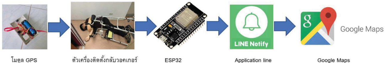
รูปที่ 21 ลักษณะการทำงานของระบบ GPS ของตัวเครื่อง
