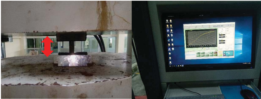
รูปที่ 7 การทดสอบ Tensile Strength เพื่อเปรียบเทียบความแข็งแรงของแนวเชื่อม
