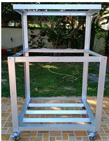
รูปที่ 4 โครงสร้างระบบสูบน้ำเคลื่อนที่พลังงานแสงอาทิตย์
