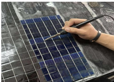
รูปที่ 7 แสดงการเชื่อมแผงโซลาร์เซลล์
