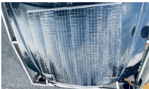
รูปที่ 12 แสดงฝากระโปรงติดตั้งแผงโซลาร์เซลล์
