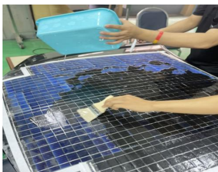
รูปที่ 9 แสดงการเคลือบผิวด้วยเรซิน
