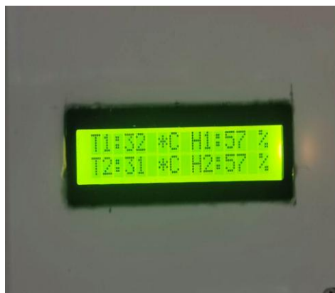
รูปที่ 2 ชุดแสดงผลอุณหภูมิและความชื้นเครื่องปรับอากาศแบบแยกส่วน
