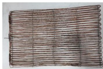
รูปที่ 5 ท่อความร้อนแบบส่นชนิดวงรอบที่สร้างขึ้น
