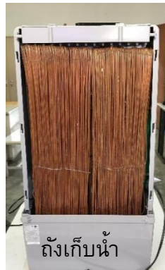
(a) ด้านหน้าพัดลมเย็นสำหรับ อากาศขาออก (b) ด้านหลังพัดลมเย็นสำหรับ ดูดอากาศขาเข้า ภาพที่ 4 การติดตั้งท่อความร้อนเข้ากับพัดลมเย็น
