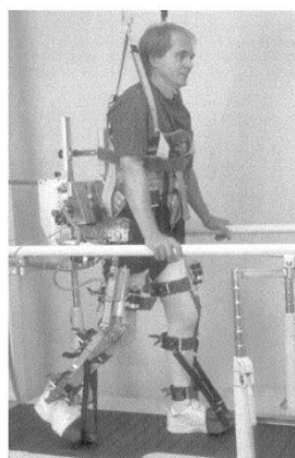
รูปที่ 2 Treadmill training of paraplegic patients using a robotic
