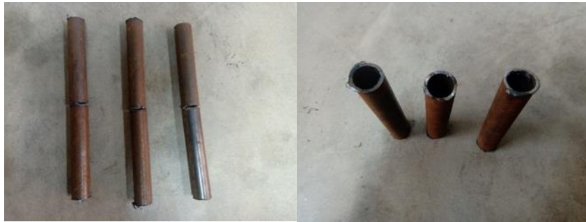
รูปที่ 2 แสดงท่อเหล็กบางที่ใช้เป็นชิ้นงานตัวอย่างในการเชื่อมอาร์คไฟฟ้า
