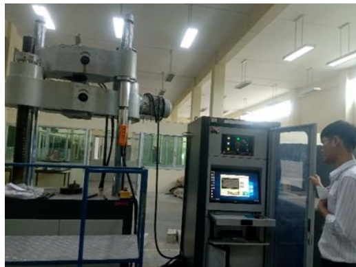
รูปที่ 5 เครื่องทดสอบความแข็งแรงของวัสดุ Universal Testing Machine
