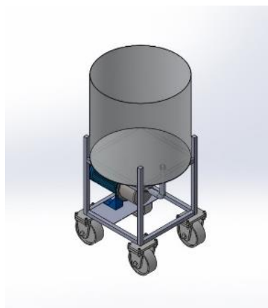
รูปที่ 6 ถังพักน้ำบุง[6]
