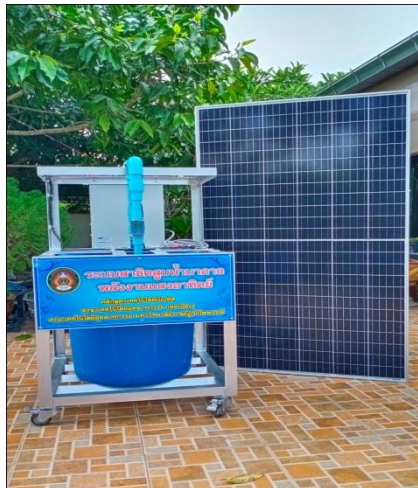
รูปที่ 5 ระบบสาธิตสูบน้ำบาดาลน้ำตื้นพลังงานแสงอาทิตย์ขนาดเล็กสำหรับใช้ในครัวเรือน
