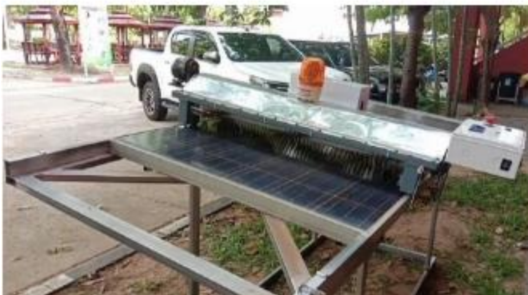
รูปที่ 12 ขณะทำการทดสอบความเร็วการเคลื่อนที่ของเครื่องทำความสะอาดแผงเซลล์แสงอาทิตย์
