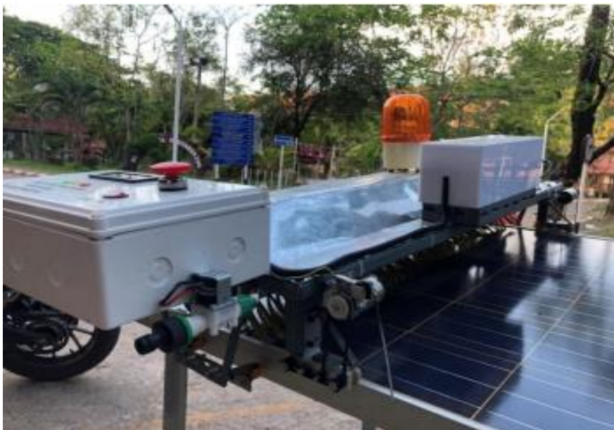
รูปที่ 4 โครงสร้างเครื่องทำความสะอาดแผงเซลล์แสงอาทิตย์ที่ถ่ายจากภาพจริง
