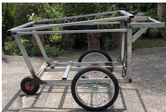
รูปที่ 4 โครงสร้างระบบสูบน้ำเคลื่อนที่พลังงานแสงอาทิตย์
