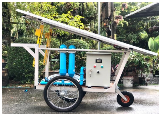
รูปที่ 5 ระบบสูบน้ำเคลื่อนที่พลังงานแสงอาทิตย์สำหรับชุมชนฐานรากในระดับครัวเรือน
