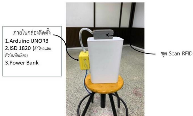
รูปที่ 1 แสดงการออกแบบอุปกรณ์ภายนอกของการคัดแยกขยะ
