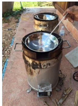
รูปที่ 10 การทดสอบประสิทธิภาพการใช้งานทางความร้อน
