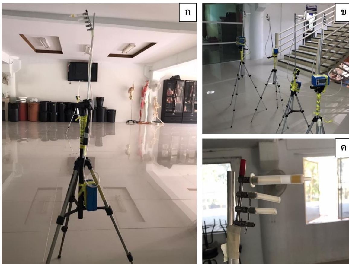
รูปที่ 1 ก) การติดตั้งชุดอุปกรณ์เก็บตัวอย่างฟอร์มัลดีไฮด์ในห้องปฏิบัติการกายวิภาค ข) ชุดอุปกรณ์เก็บตัวอย่างอากาศ และ ค) หลอดเก็บตัวอย่างอากาศ
