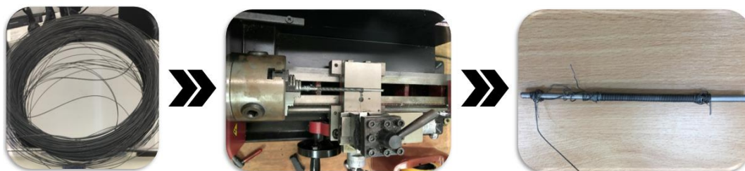
รูปที่ 2 การสร้างสปริงจากลวดโลหะผสมจำรูปนิกเกิล-ไทเทเนียม
