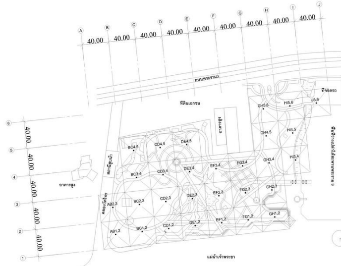
รูปที่ 3 ตัวอย่างแบบแปลนแสดงตำแหน่ง 29 จุดพิกัดของสวนเฉลิมพระเกียรติฯ
