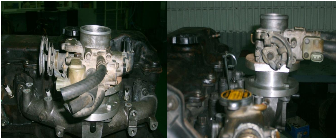
รูปที่ 3 ติดตั้งลิ้นปีกผีเสื้อเพื่อควบคุมปริมาณอากาศที่ไหลเข้าสู่เครื่องยนต์
