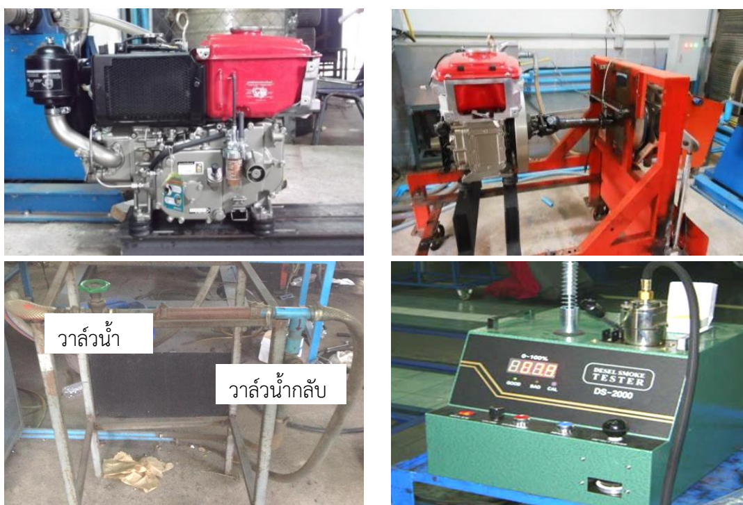
รูปที่ 1 เครื่องยนต์ยี่ห้อคูโบต้า รุ่น RT 100 (a) ชุดทดสอบไดนาโมมิเตอร์แบบไฮดรอลิกเบรก (b) วาล์วน้ำเข้าและวาล์วน้ำไหลกลับถึงเก็บน้ำ (c) อุปกรณ์ทดสอบควันดำของเครื่องยนต์ดีเซล (d)
