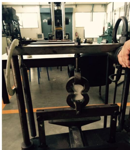
รูปที่ 6 การหาความต้านทานการรับแรงดึงรับแรงดึงขณะทำการทดสอบ
