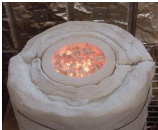
ภาพที่ 2 ลักษณะโครงสร้างวัสดุพูนแบบแยกจากกัน รูปทรงอานม้า (Ceramic saddles) ขณะใช้งาน
