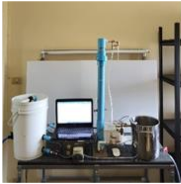
รูปที่ 1 ระบบการล้างชีวมวลด้วยน้ำ
