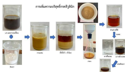
ภาพที่ 10 การเพิ่มความบริสุทธิ์กรดสัลฟอนิกด้วยการเติมดินเบา
