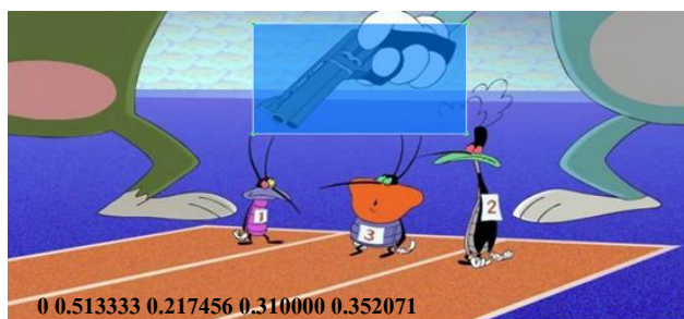
รูปที่ 7 ตัวอย่างการตีกรอบสี่เหลี่ยมเพื่อกำหนดตำแหน่งวัตถุที่สนใจด้วยโปรแกรม labelImg (เครดิตภาพการ์ตูนระบุในหัวข้อ Data Collection)
