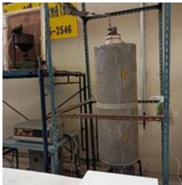
รูปที่ 2 ตัวเตาปฏิกรณ์เผาไหม้แบบฟลูอิดไคเซเบด
