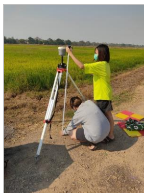
รูปที่ 4 (a) การเก็บข้อมูลจุดอ้างอิงสำหรับตรึงพิกัดภาพถ่ายจาก UAV (b) การติดตั้งเป้าอ้างอิงก่อนการบินเก็บข้อมูล
