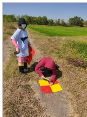
รูปที่ 4 (a) การเก็บข้อมูลจุดอ้างอิงสำหรับตรึงพิกัดภาพถ่ายจาก UAV (b) การติดตั้งเป้าอ้างอิงก่อนการบินเก็บข้อมูล
