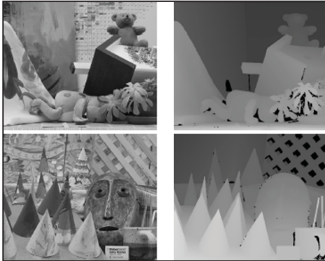
ภาพที่ 4 ตัวอย่างภาพจากชุดข้อมูล (ซ้าย) และผลจากการหาระยะลึกที่ปรากฏในฉาก (ขวา)
