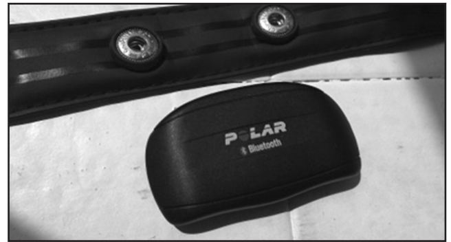
ภาพที่ 6 อุปกรณ์วัดอัตราการเต้นหัวใจ รุ่น Polar Wear Link ®+with Bluetooth transmitter [7]
