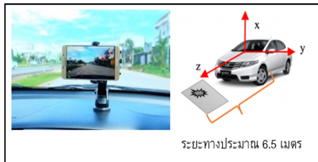
ภาพที่ 2 การติดตั้งโทรศัพท์สมาร์ทโฟนและระยะทางที่ใช้ในการตรวจจับสภาพพื้นผิวถนน
