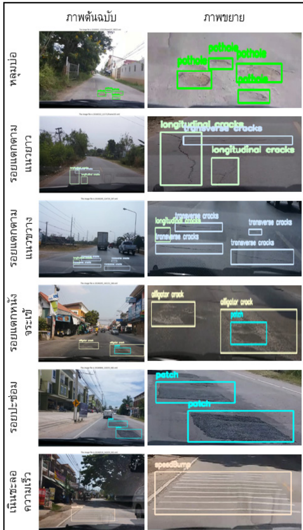
ภาพที่ 3 ตัวอย่างชุดข้อมูล RSAD ที่ถูกสร้างกรอบล้อมวัตถุและระบุประเภทสภาพพื้นผิวถนนที่ผิดปกติ
