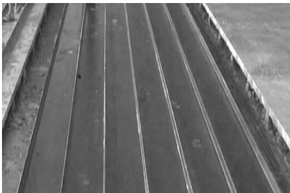
รูปที่ 2 รางแม่แบบสำหรับผลิตแผ่นพื้นสำเร็จรูป
