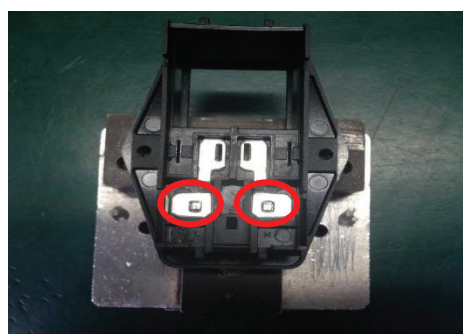
รูปที่ 1 แสดงบริเวณที่มีการเชื่อมต่อระหว่างขาพินของปลั๊กกับชิ้นส่วนเชื่อมต่อ
