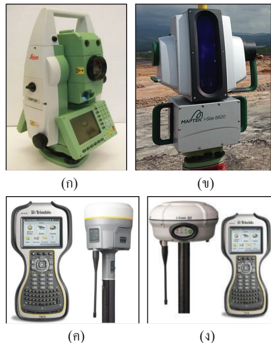
รูปที่ 8 อุปกรณ์ที่ใช้ในการวิจัยที่เหมืองแม่เมาะ (ก) กล้องประมวลผลรวม Leica TCRA 1203/1205 (ข) เครื่องเลเซอร์สแกน Maptek I site 8820 (ค) เครื่องรับสัญญาณดาวเทียม GNSS Trimble R10 (ง) เครื่องรับสัญญาณดาวเทียม GNSS Trimble R8
