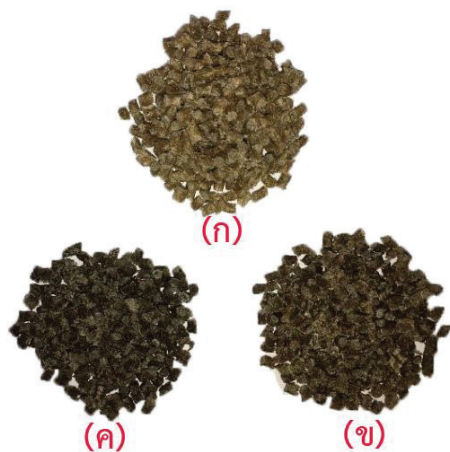
รูปที่ 3 เม็ดวัสดุเชิงประกอบพลาสติกและ (ก) ผงไม้ยางพารา (ข) ผงไม้ปาล์มน้ำมัน และ (ค) ผงไม้ทังไบปาล์มน้ำมัน
