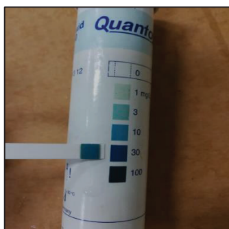
รูปที่ 4 การวัดไฮโดรเจนเปอร์ออกไซด์ด้วยกระดาษทดสอบเปอร์ออกไซด์
