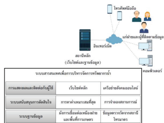
รูปที่ 4 องค์ประกอบระบบสนับสนุนการตัดสินใจสำหรับปรับระดับประตูน้ำของเหมืองฝาย
