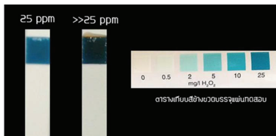
รูปที่ 7 การทดสอบเพอร์ออกไซด์ในน้ำกลั่น (ซ้าย) และใช้ไมโครบับเบิล (ขวา) เป็นตัวดูดซับ
