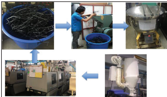
รูปที่ 15 ระบบการคัดพลาสติกและกระบวนการแบบเดิม
