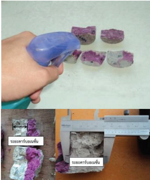
รูปที่ 4 การทดสอบและวัดความลึกคาร์บอนขึ้น
