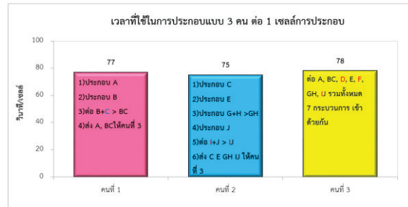
รูปที่ 20 เวลาที่ใช้ในการประกอบของแต่ละคนในระบบ 3 คน ต่อ 1 เซลล์การประกอบ
