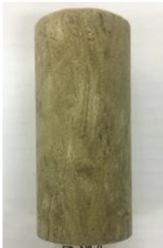
รูปที่ 2 ตัวอย่างของโพลีเอทิลีนรูปทรงกระบอกที่เตรียมจากเครื่องมือเตรียมตัวอย่างรูปทรงกระบอกแบบชุดลูกสูบ
