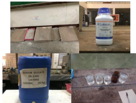
รูปที่ 1 รูปหินคลุก สารละลายโซเดียมไฮดรอกไซด์ และสารละลายโซเดียมซิลิเกต
