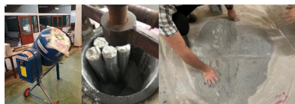
รูปที่ 2 การเตรียมตัวอย่างหินคลุก
