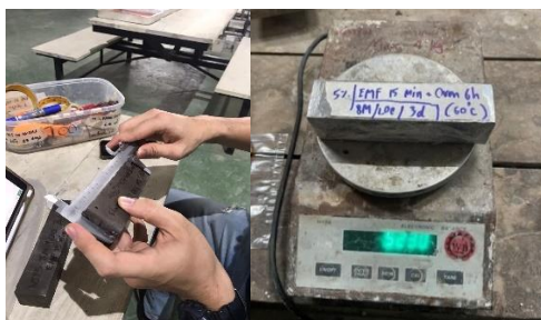
รูปที่ 7 วัดขนาดความกว้าง (b), ความสูง (h), ความยาว (L) และชั่งน้ำหนักของวัสดุตัวอย่างจีโอโพลิเมอร์
