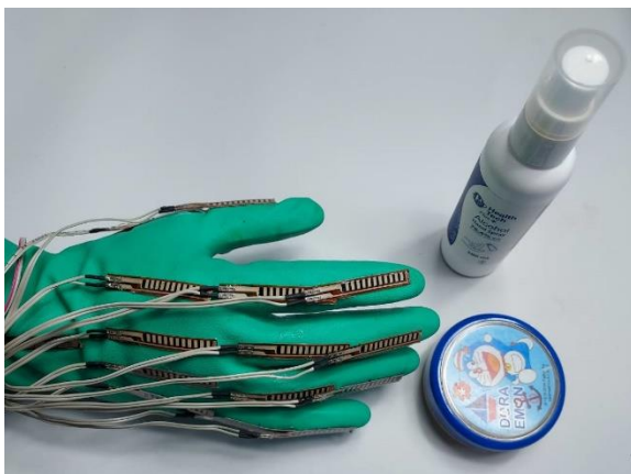
รูปที่ 8 ถุงมือที่ติดตั้ง Flex Sensor แบบ 16 DoF
