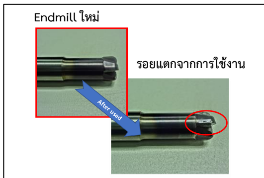
รูปที่ 2 แสดงรอยแตกจากการใช้งานของดอกกัด
