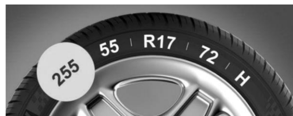
รูปที่ 1 คำอธิบายขนาดทางกายภาพบนแก้มยาง [4]
