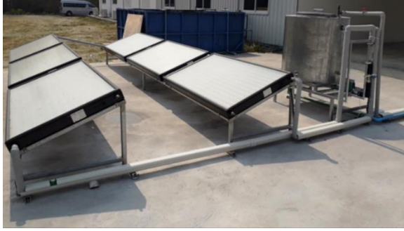
รูปที่ 7 การใช้โมดูลโฟโตวอลเทอิก/ความร้อนแบบมีกระจก ในการผลิตไฟฟ้าและน้ำร้อน (ได้รับความอนุเคราะห์จากห้องปฏิบัติการวิจัยทางอุณหพลศาสตร์ ภาควิชาวิศวกรรมเครื่องกล คณะวิศวกรรมศาสตร์ มหาวิทยาลัยเชียงใหม่)
