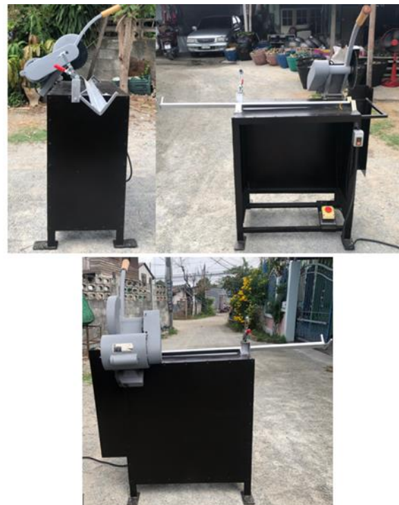
รูปที่ 15 เครื่องเลื่อยกระบอกไม้ไผ่ต้นแบบเครื่องใหม่
