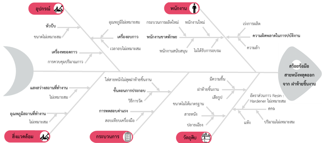
รูปที่ 5 การวิเคราะห์แผนภูมิแก๊งปลาแสดงสาเหตุการเกิดของเสียสร้อยข้อมือสายหนังหลุดออกจากฟ้าย้ายขึ้นงาน
