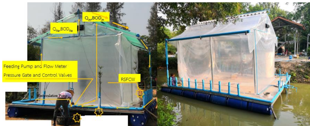
รูปที่ 2 หน่วยระบบบำบัดน้ำเสียบึงประดิษฐ์การไหลเวียนใต้ชั้นกรอง (Unit Operation Recirculation Subsurface Flow Constructed Wetland: RSFCW)
