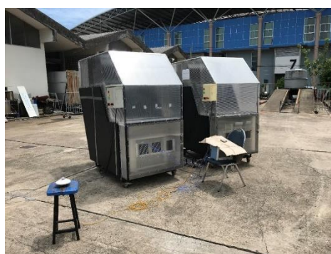
รูปที่ 1 ระบบปั๊มความร้อนรังสีอาทิตย์เสริมด้วยเรือนกระจก [22]
