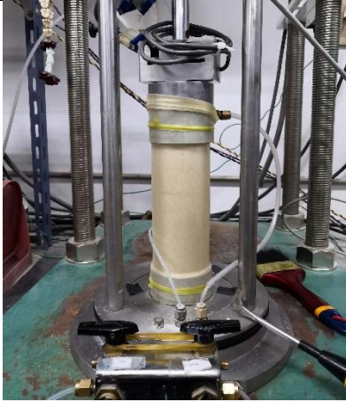
รูปที่ 6 ตัวอย่างทราย KMUTT ภายหลังการแกะ โมลออกเพื่อใช้สำหรับการทดสอบสามแกน
